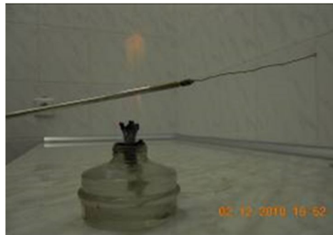
Рис. 4 Обпалювання ручки мікробіологічної петлі
