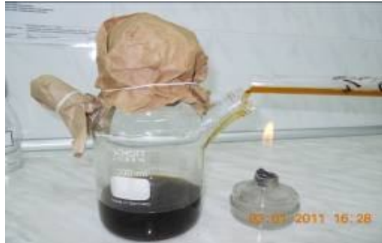
Рис. 7 Переливання сусла з ЧКД в колбу
