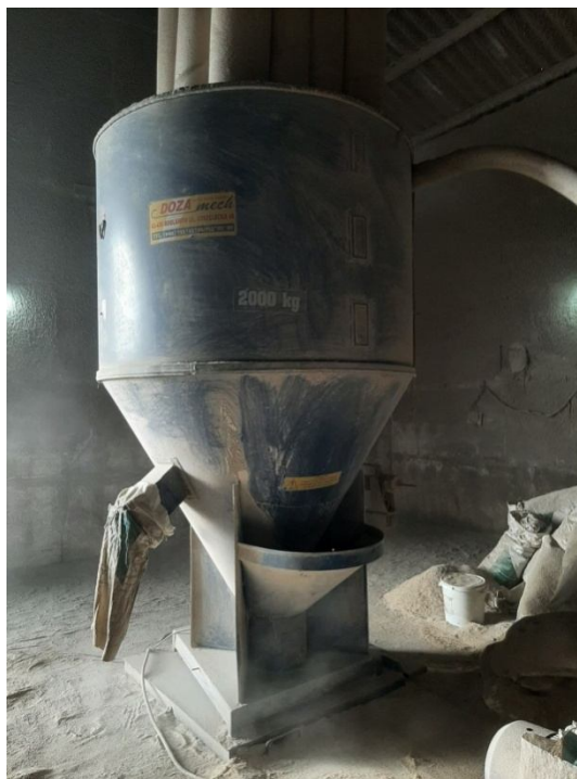
Рис. 4 Кормозмішувач «Дозамех» ємністю 2000 кг
