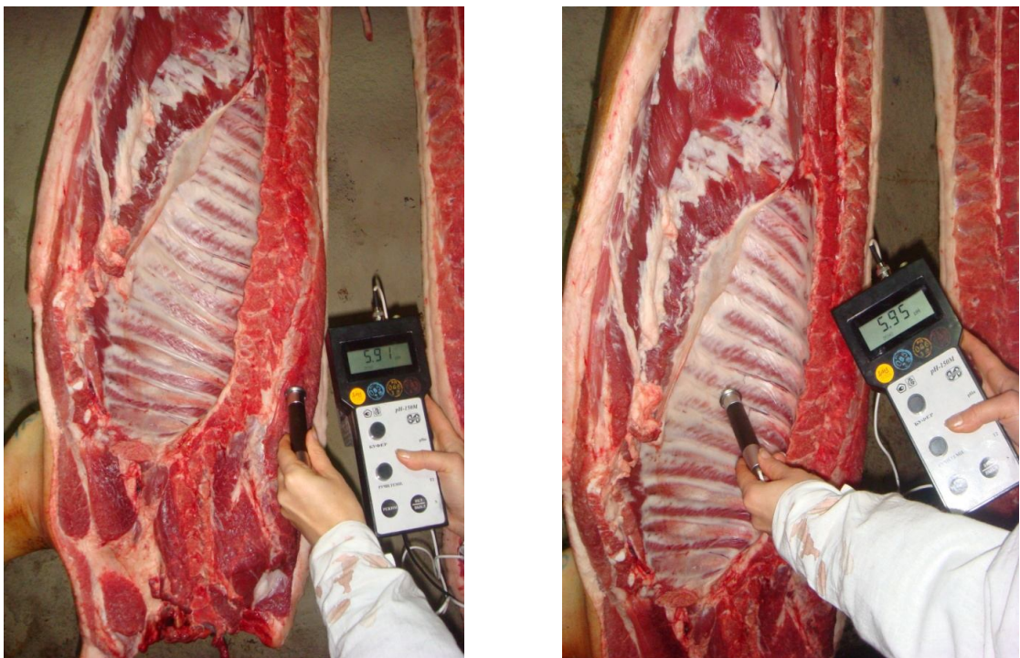
Рис. 3.2. Вимірювання величини активної кислотності в м'язах туші свині портативним приладом рН-метр 150М
