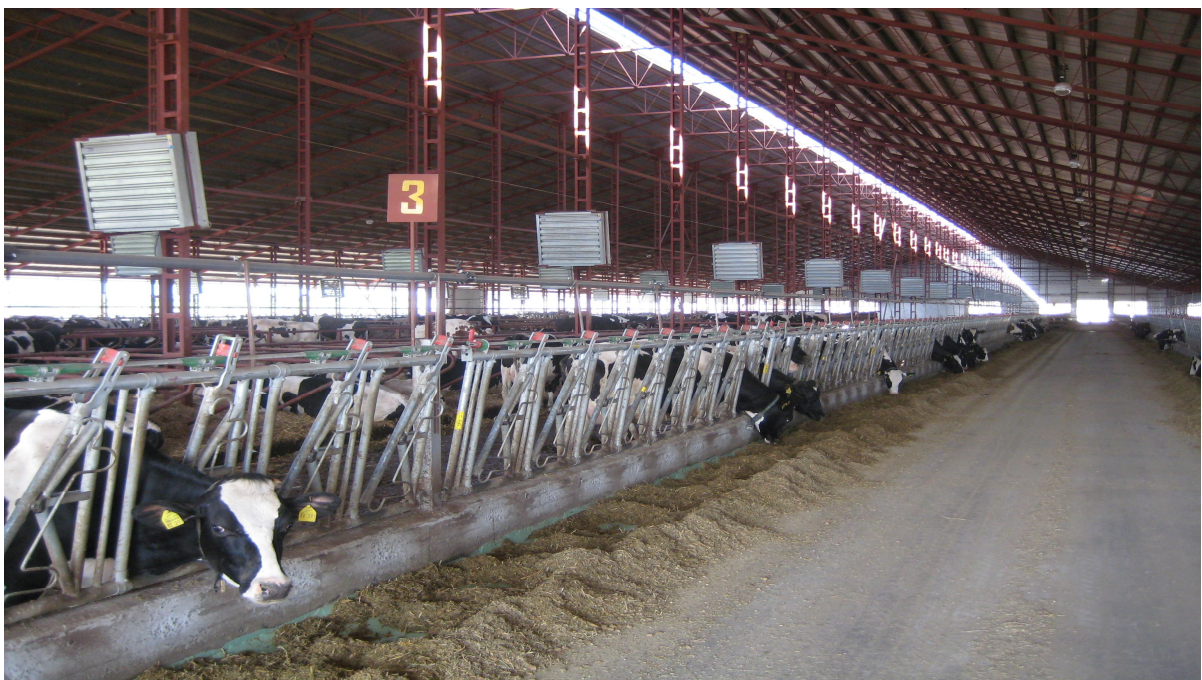
Рис. 5. Обмежувач кормового столу з фіксуєчими хедлоками, кормовий стіл і кормовий прохід
