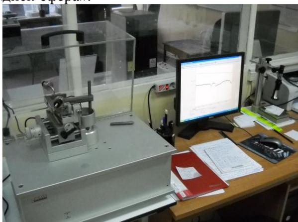
Рис. 1. Внешний вид трибометра TRB - S - DE
