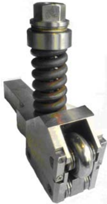
Рис. 5. Общий вид устройства для обкатывания деталей торообразным роликом со стабилизацией рабочего усилия обкатывания
