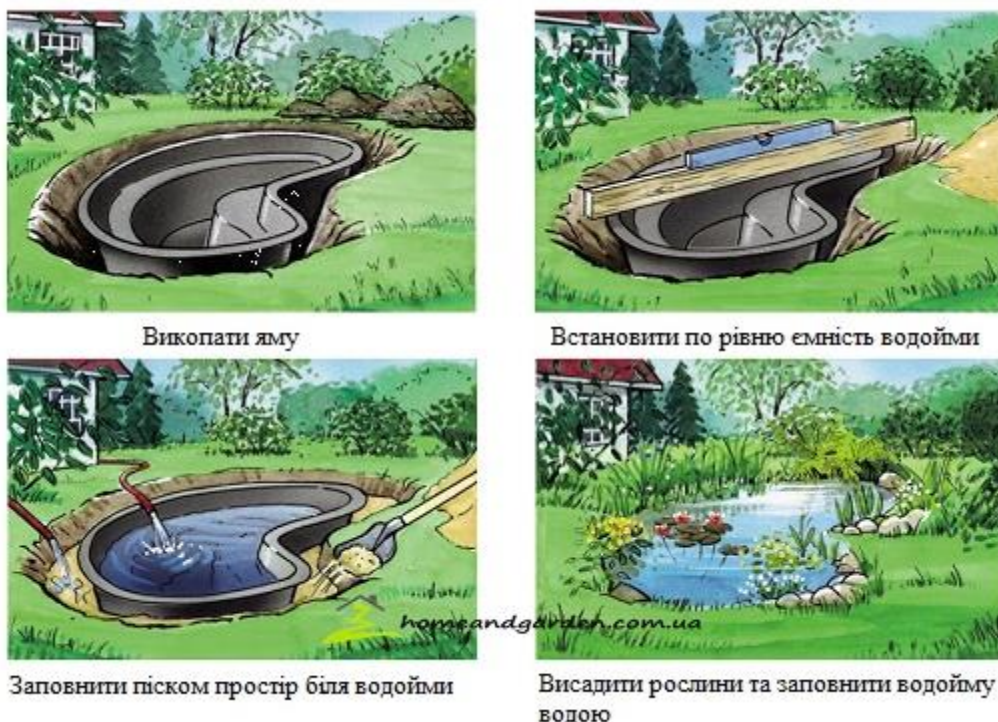
Рис. 11 Створення декоративної водойми з ємності
