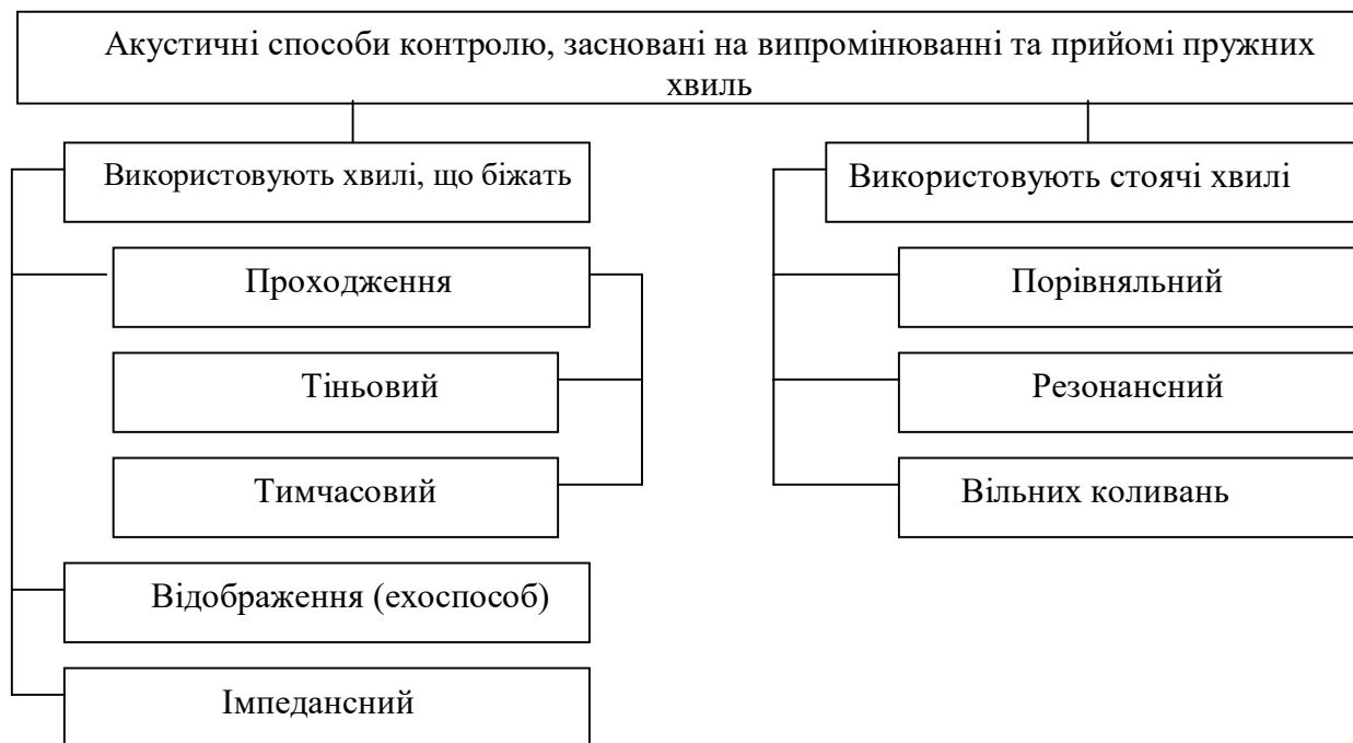
Мал. 2.18. Класифікація акустичних способів визначення тріщин
