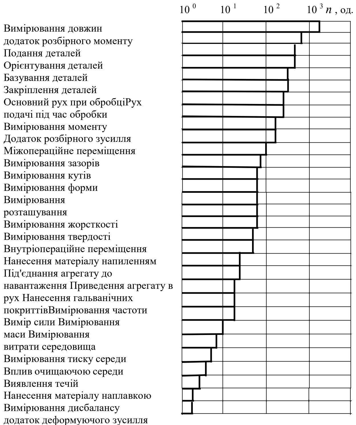
Мал. 1.5. Кількість n технологічних переходів, припадаючих на ремонт одного двигуна внутрішнього згорання
