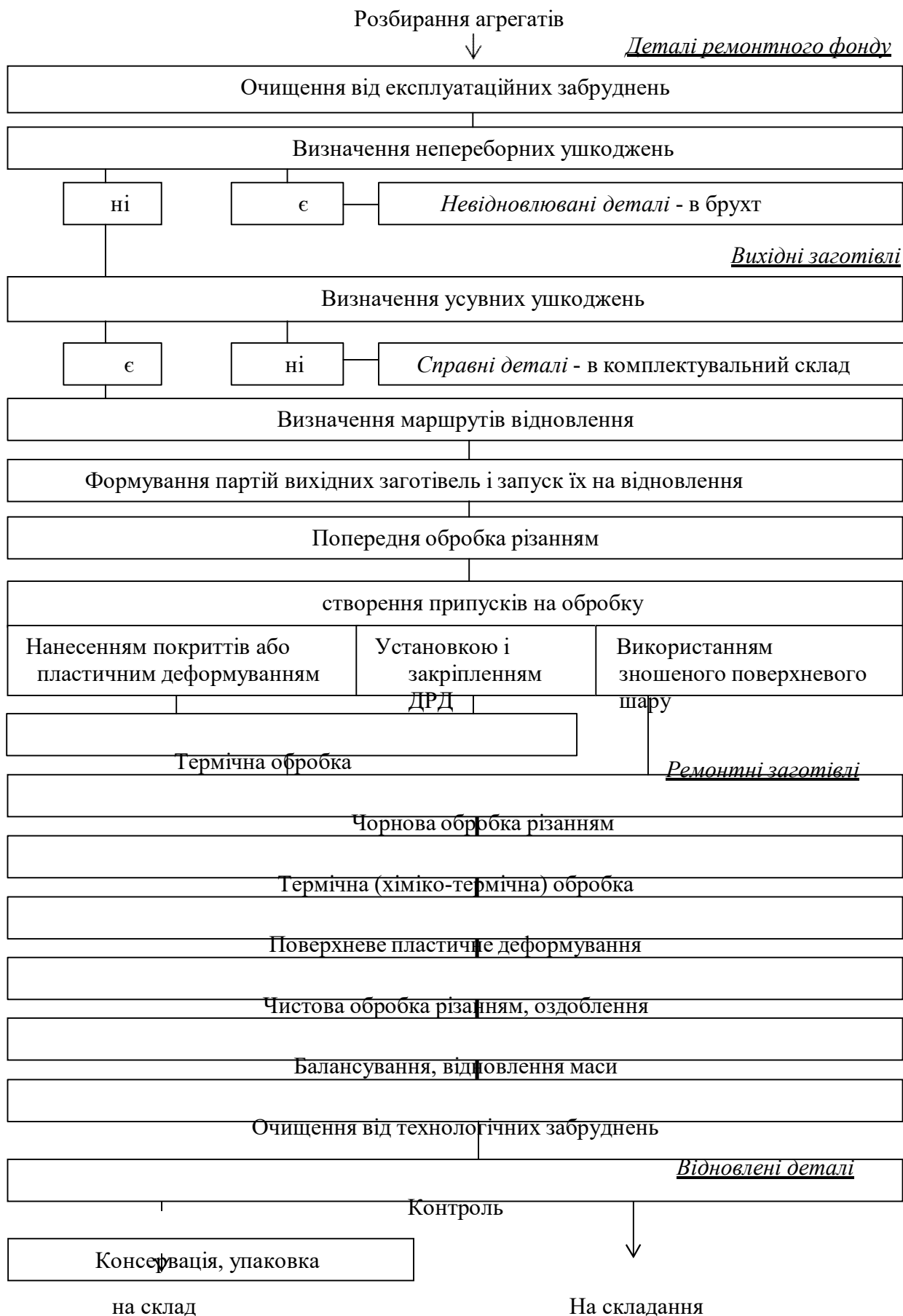
Мал. 2.24. Схема технологічного процесу відновлення деталей
