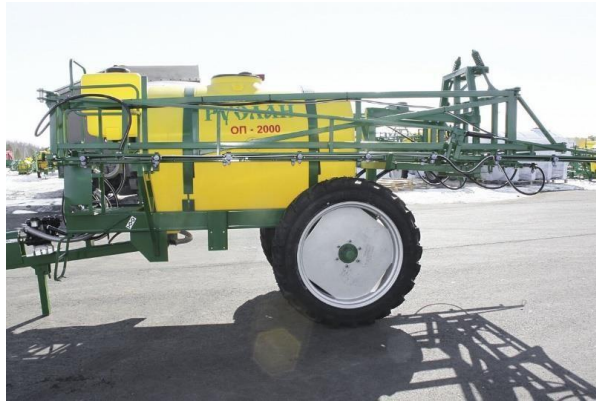
Рис.3. Обприскувач причіпний штанговий ОП-2000-2-01
