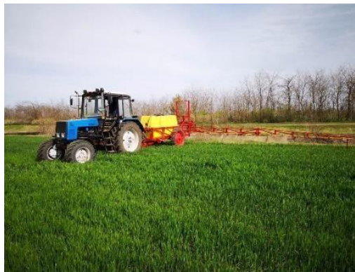
Рис.4. Фотографія обприскувача серії ОП на полі, що агрегатується з трактором МТЗ-80
