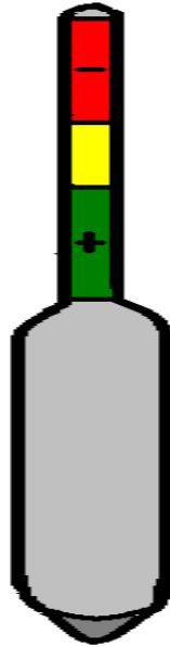
Рис. 4. Колострометр для визначення якості молозива
