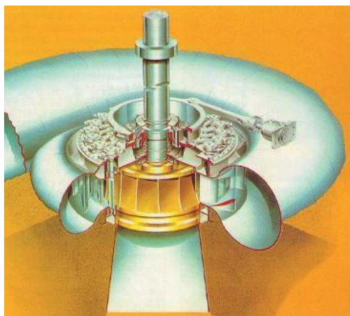
Рис. 4.8. Схематичне зображення спіральної камери й турбіни
