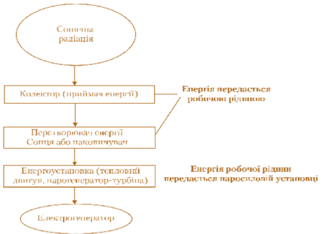
Рис.2.1. Принципова схема отримання електричної енергії
