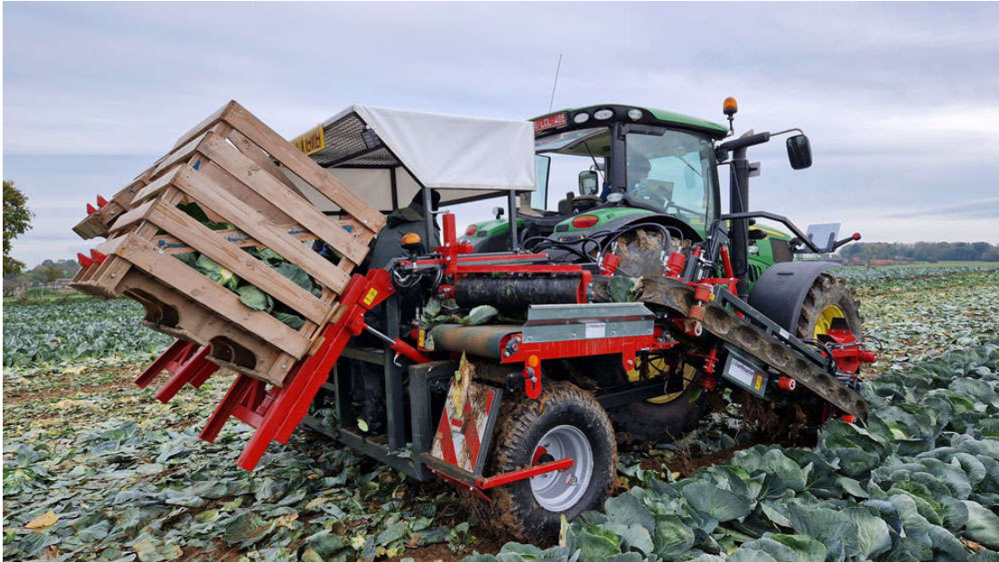
Рис 1.3. Процес збирання врожаю комбайном VITUS Brassica Storag.
