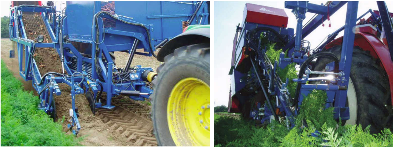
Рис. 2.3; 2.4. Процес збирання моркви комбайном Asa Lift
