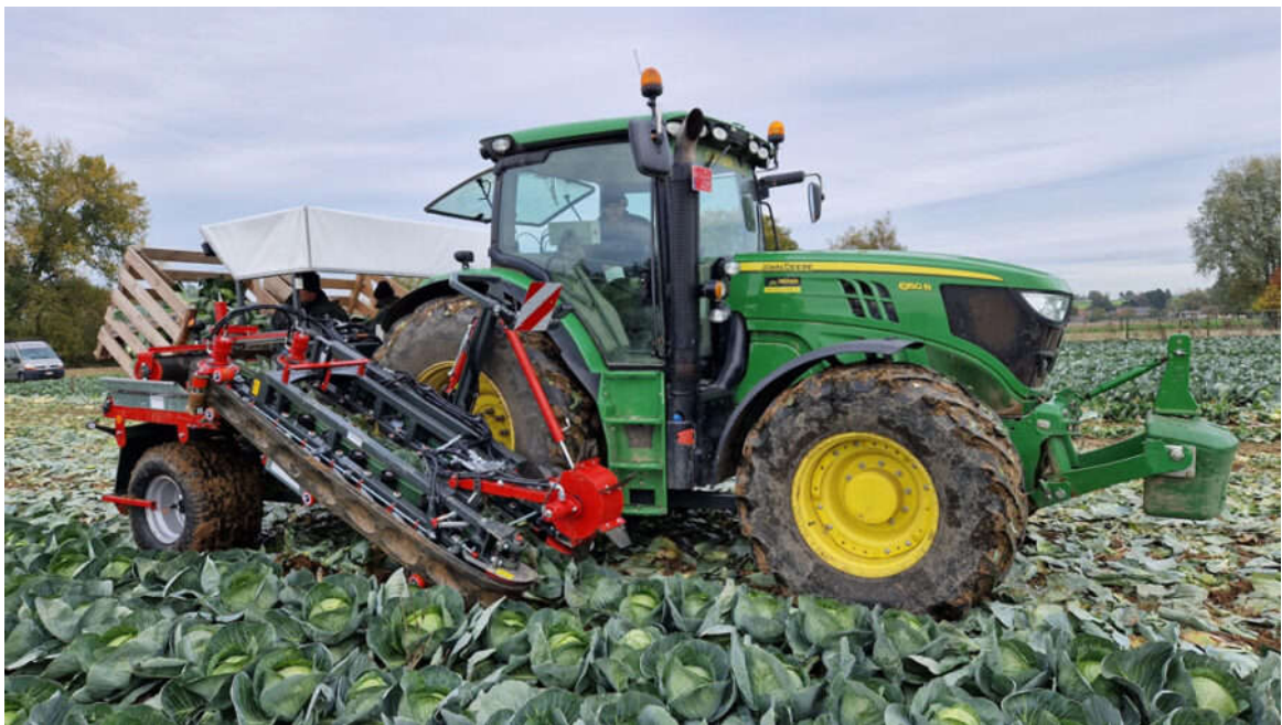
Рис.1.2. Процес збирання врожаю комбайном VITUS Brassica Storage.
