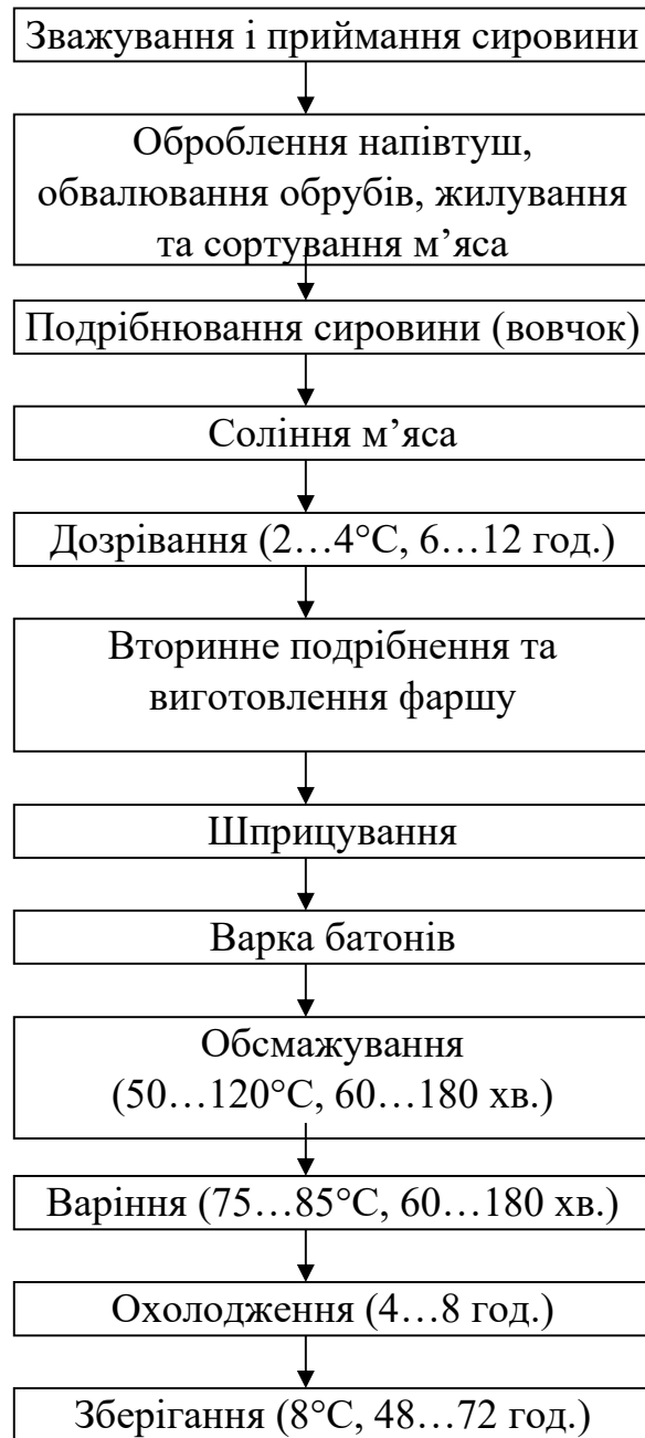
Рис. 3. Технологічна схема виготовлення варених ковбас
