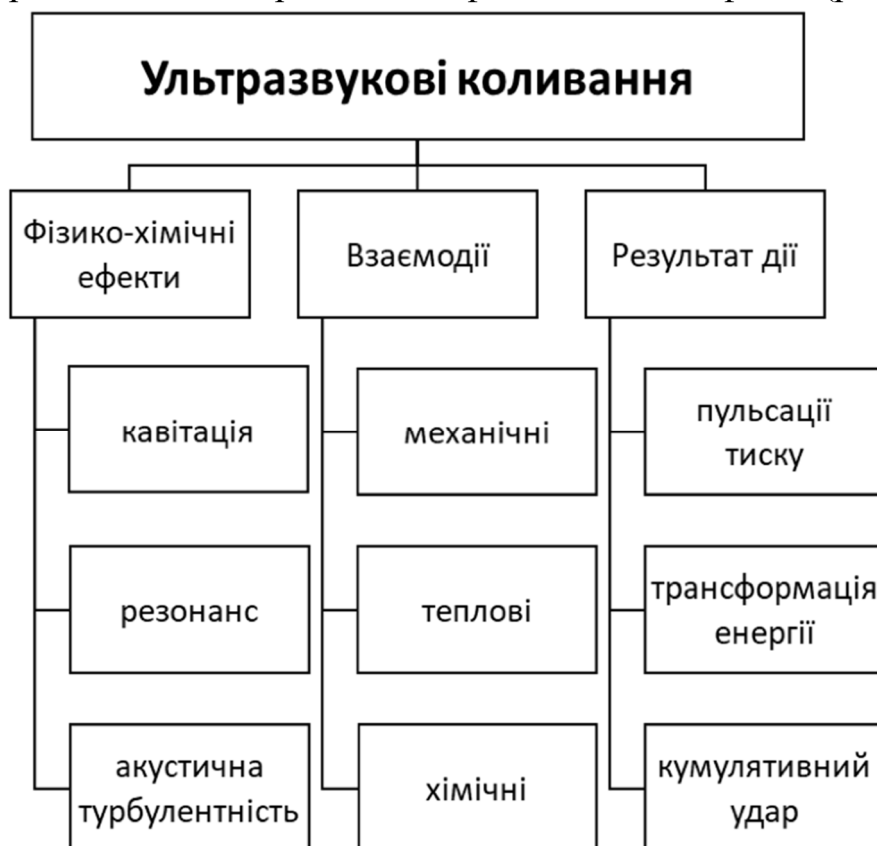
Рис. 6. Схема дії акустичних коливань на хіміко-технологічну систему
