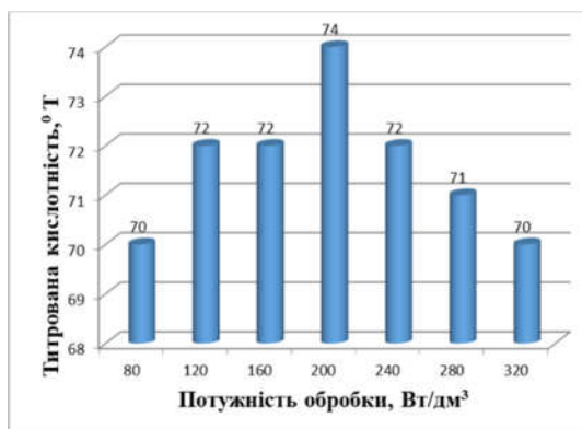
Рис. 17. Динаміка титрованої кислотності у зразках молока за тривалості ультразвукової обробки 180 секунд та різної потужності
