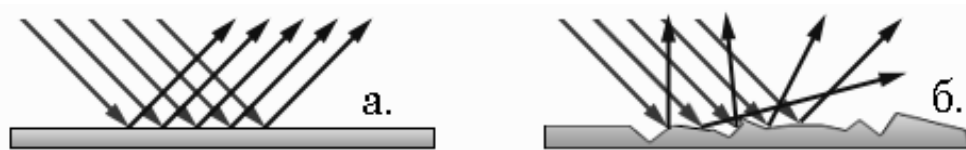
Рис 21. Види відбиття: а) дзеркальна, б) дифузна
