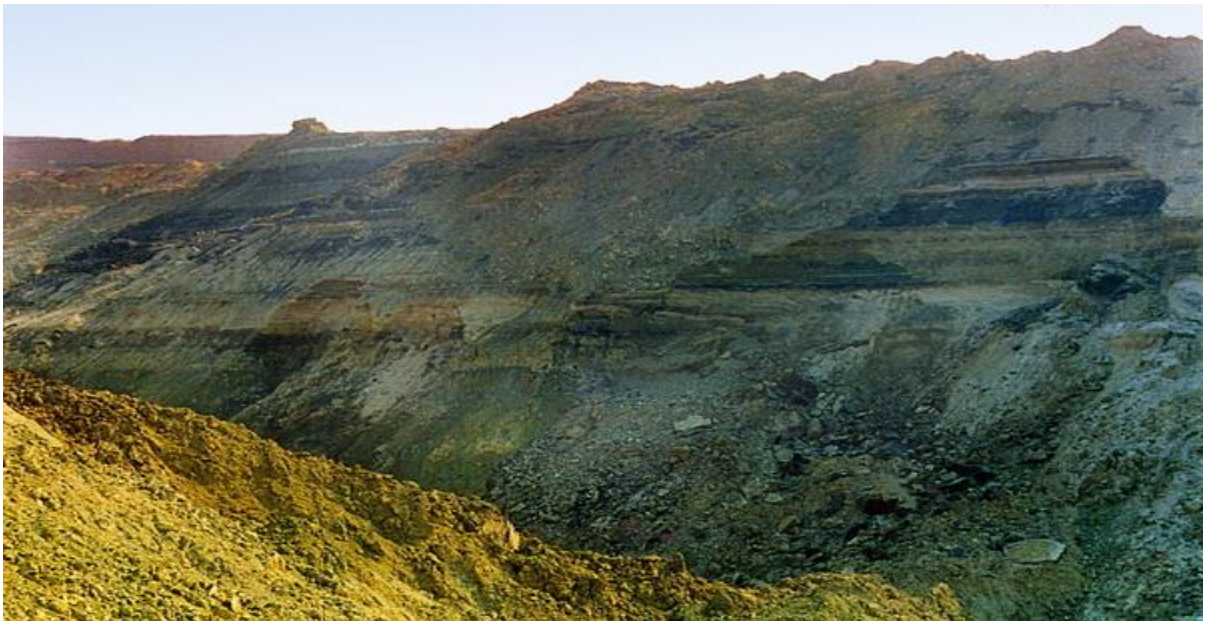
Рис. 2. Кар'єр на Марганцевському родовищі з 2-метровий рудним пластом
