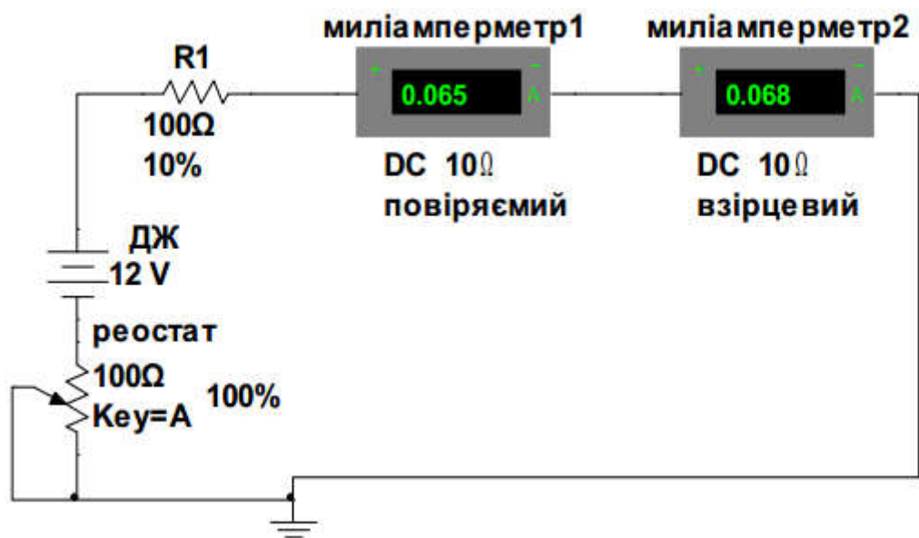
Рис.1 Приклад схеми для перевірки міліамперметру.
