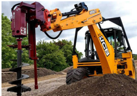
Рис.2. Моторизована бурова установка
