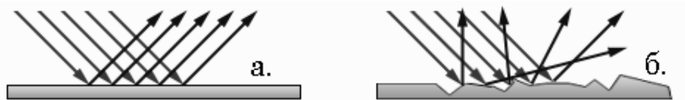
Рис 21. Види відбиття: а) дзеркальна, б) дифузна
