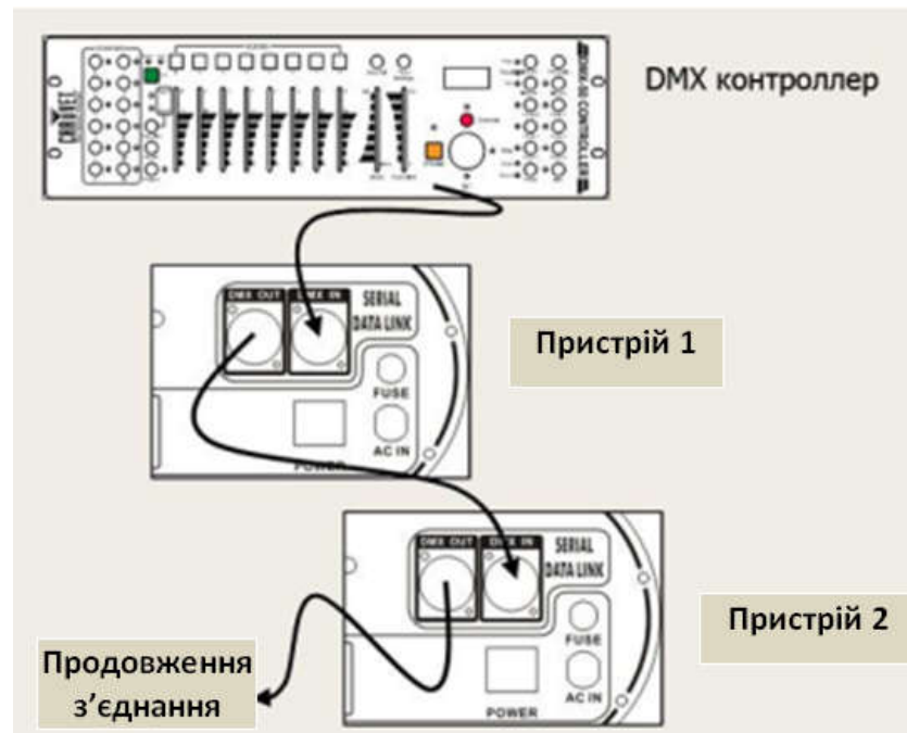
Рис. 14.4 – Спосіб і порядок підключення декількох світильників до одного контролера
