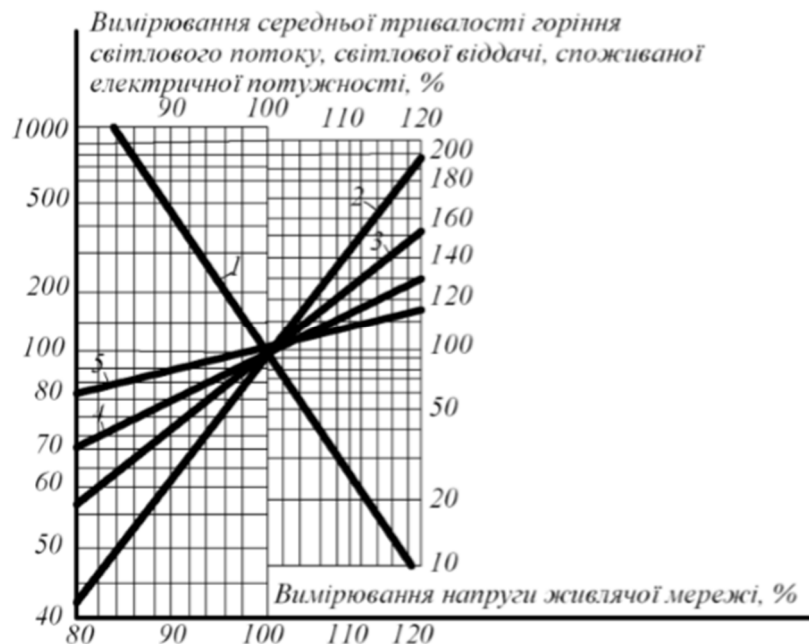
Рис. 4.5 – Залежність світлотехнічних, електричних і експлуатаційних параметрів ламп розжарювання загального призначення від зміни напруги живлячої мережі: 1 - середня тривалість горіння; 2 - світловий потік; 3 - світлова віддача; 4 - споживана потужність; 5 - сила струму
