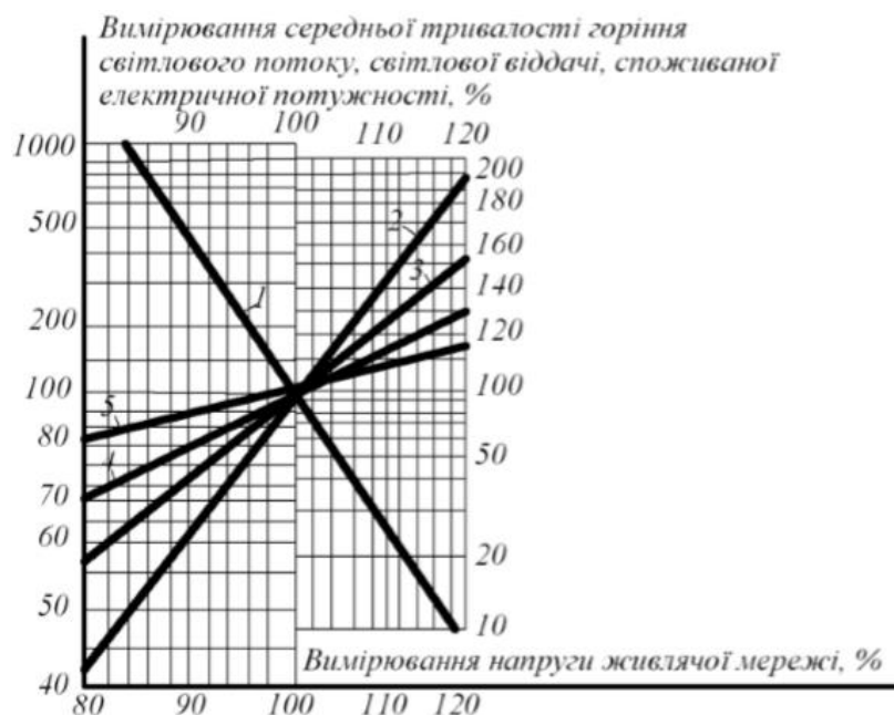
Рис. 5 – Залежність світлотехнічних, електричних і експлуатаційних параметрів ламп розжарювання загального призначення від зміни напруги живлячої мережі: 1 – середня тривалість горіння; 2 – світловий потік; 3 – світлова віддача; 4 – споживана потужність; 5 – сила струму.
