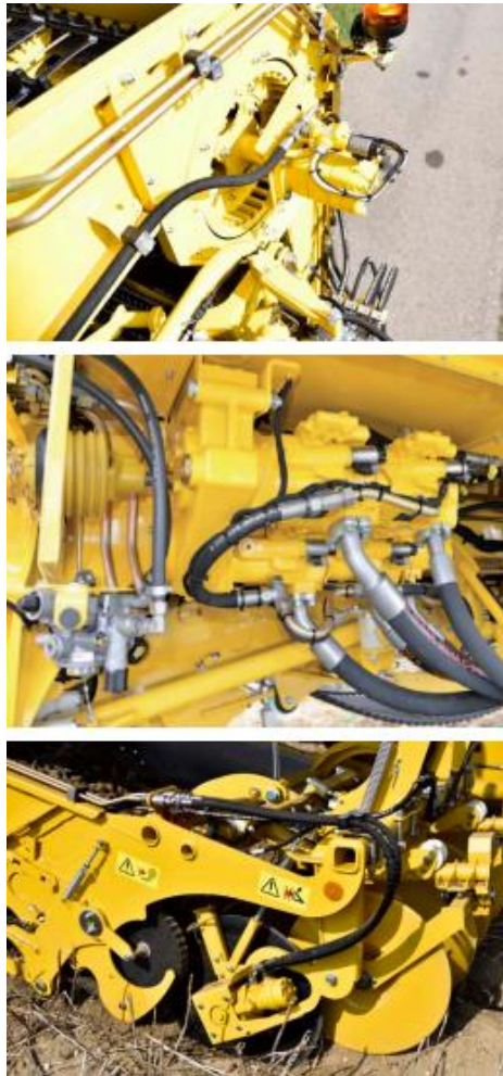
Рис.3.4. Повногідравлічний привід картоплезбирального комбайна Ropa Kieler 2
