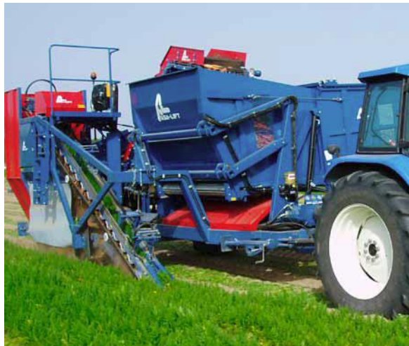
Рис. 2.2. Причіпний комбайн AsaLift
