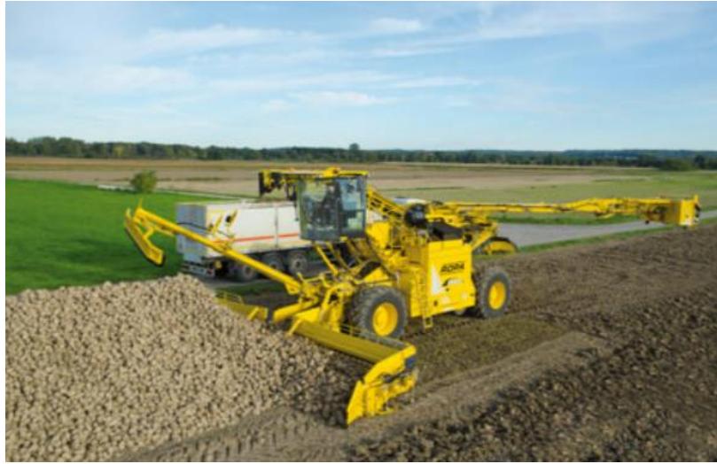
Рис.4.1.Самоочисна машина ROPA euro-Maus 4
