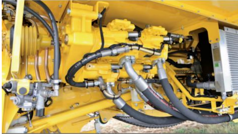
Рис.3.2. Повногідравлічний привід картоплезбирального комбайна Ropa Kieler 2
