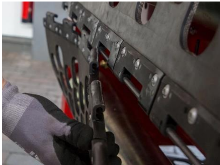
Рис. 4.7. Система швидкої заміни для сортувальних транспортерів Grimme WG 900
