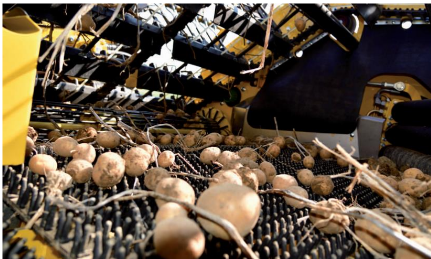
Рис.3.7. Розраховані із запасом елементи очищення ідеально скоординовані один з одним у комбайні Rora Kieler 2
