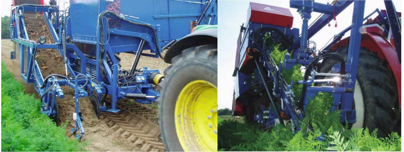
Рис. 2.3; 2.4. Процес збирання моркви комбайном AsaLift
