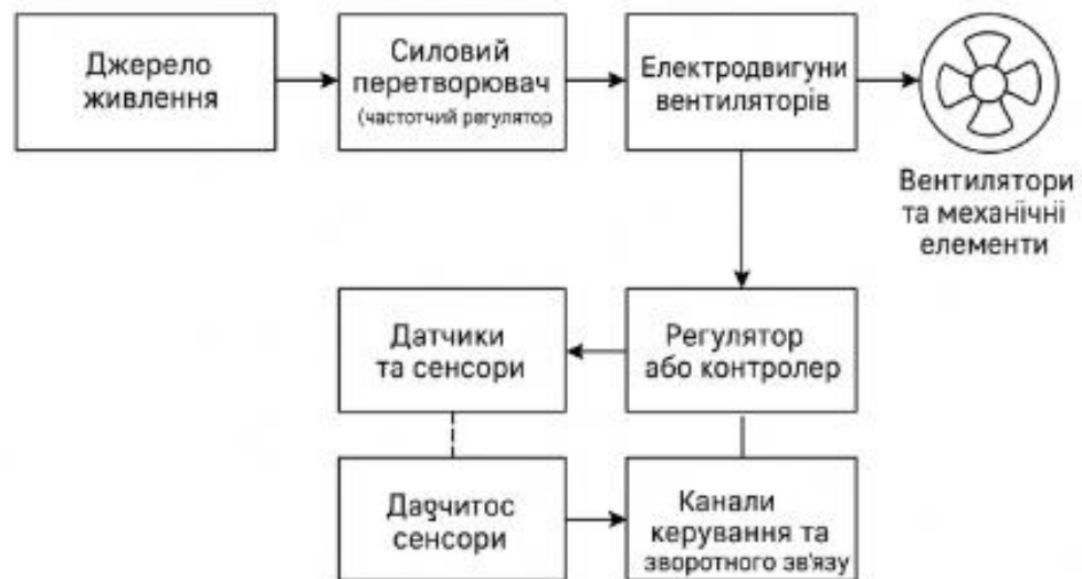
Рис. 1 – Структурна схема вентиляційної установки
