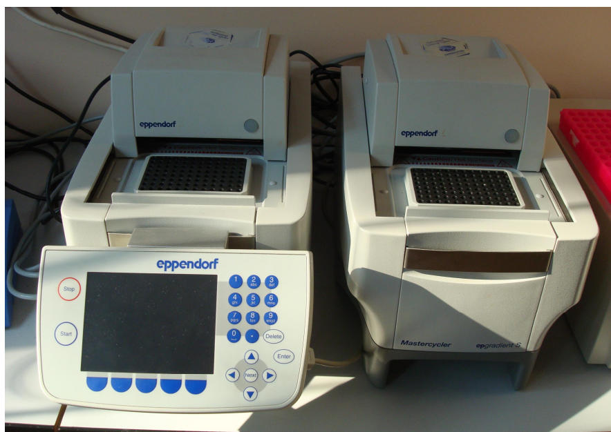
Рис. 14. Ампліфікатори – прилади, що забезпечують періодичне охолодження і нагрівання пробірок, необхідні для проведення ПЛР
