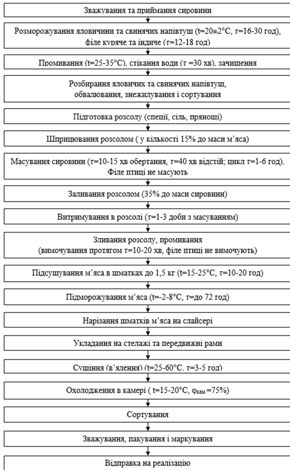
Рис. 13. Загальна технологічна схема виробництва м'ясних снєків
