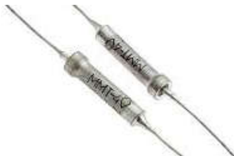
Рис. 5.8 – Зображення терморезистора ММТ-1 і ММТ-4.
