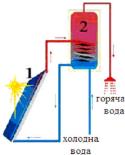
Рис. 1.3 – Системи з природною циркуляцією теплоносія:
