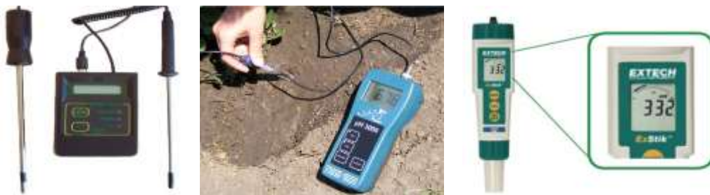
Рис. 2.1.4. Технічні засоби вимірювання агрономічних даних: вологомір ґрунту, рН-вимірювач (кислотності ґрунту), прилад для
