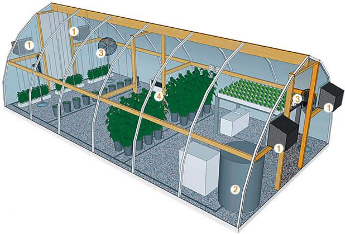
Рисунок 3.2.2.2.Варіант облаштування теплиці (1. Витяжні вентилятори; 2. Резервуар з поживним розчином; 3. Вентилятор; 4 Радіатор)
