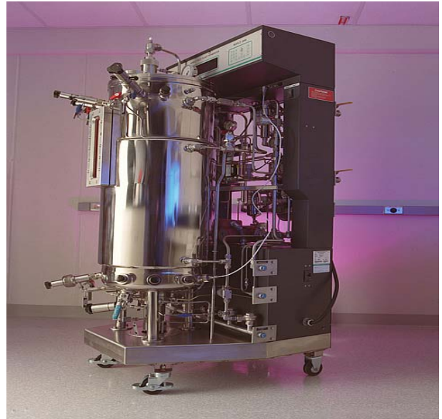
Рис. 8. Біореактор промислового типу для дослідження целюлозного етанолу
