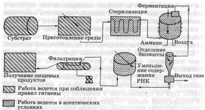
Рис. 6.6. Блок-схема производства микопроотеина (по И. Хиггинсу и др., 1988)
