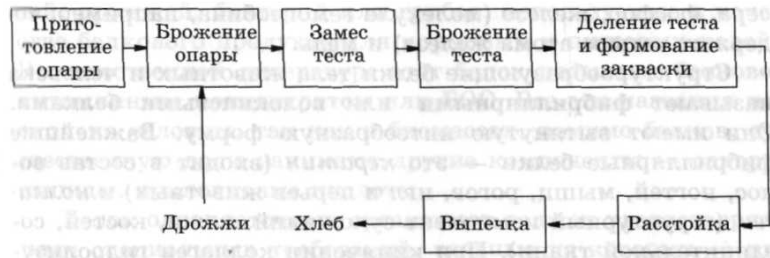
Рис. 6.5. Блок-схема производства хлеба (по В.В. Бирюкову, 2004)
