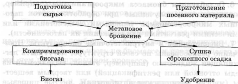
Рис. 6.3. Блок-схема производства биогаза (по В.В. Бирюкову, 2004)
