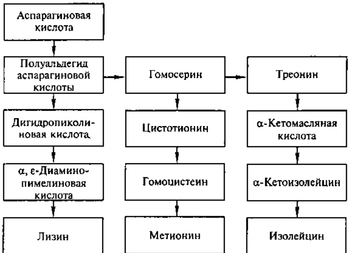
Рис. 15. Блок-схема отримання лізину, ізолейцину, метіоніну
