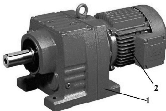
Рис. 1. Привід норії: 1 - редуктор; 2 - двигун
