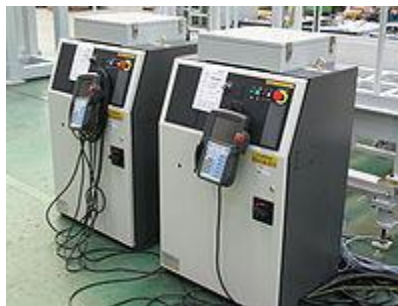
Рис. 21. Шкафи систем управління двох промислових роботів
