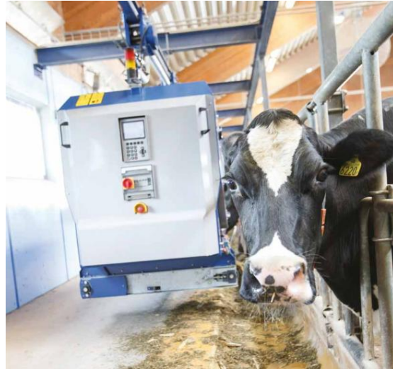
Рис. 9. Автоматизована система годування Delaval (автоматичний рельсовий кормораздатник)
