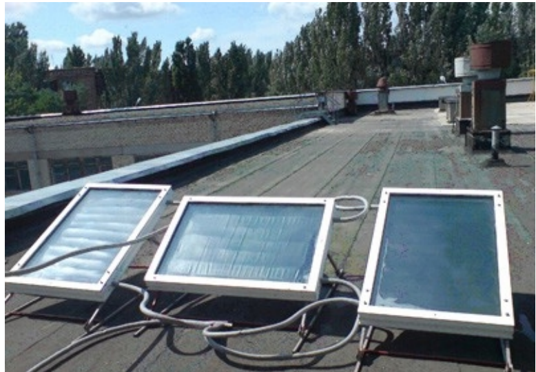
Рис. 8.1 – Лабораторний стенд теплової геліоустановки для вимірювання плоских сонячних колекторів: а – перша частина стенду; б – друга частина стенду (сонячні колектори)
