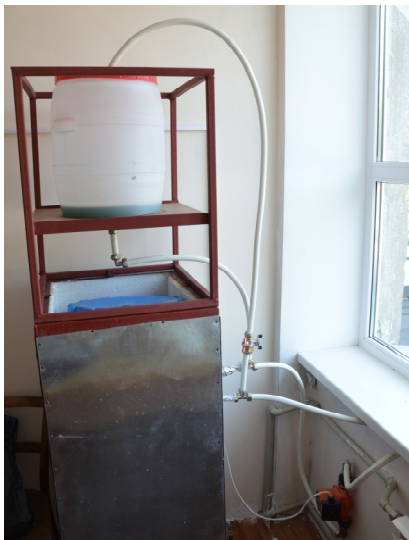
Рис. 8.1 – Лабораторний стенд теплової геліоустановки для вимірювання плоских сонячних колекторів: а – перша частина стенду; б – друга частина стенду (сонячні колектори)
