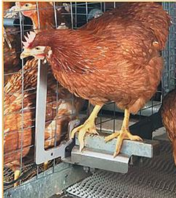
Рис. 14 Incas 2 для зважування курей
