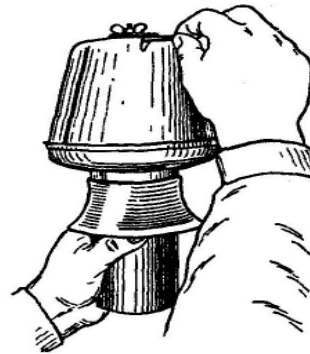
Рис 1.4. Очищення щілин для викидання пилу в повітроочиснику
