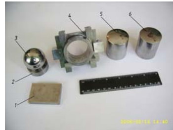
1 – пластина; 2, 5, 6 – пуансоны; 3 – шар; 4 – корпус
