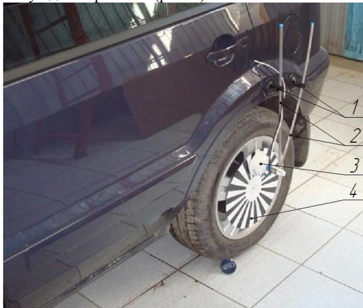
Рис. 3. Монтаж пристрою для вимірювання кутової швидкості колеса на ТЗ 1 - присоски; 2 - кронштейн; 3 - освітлювач; 4 - оптичний диск
