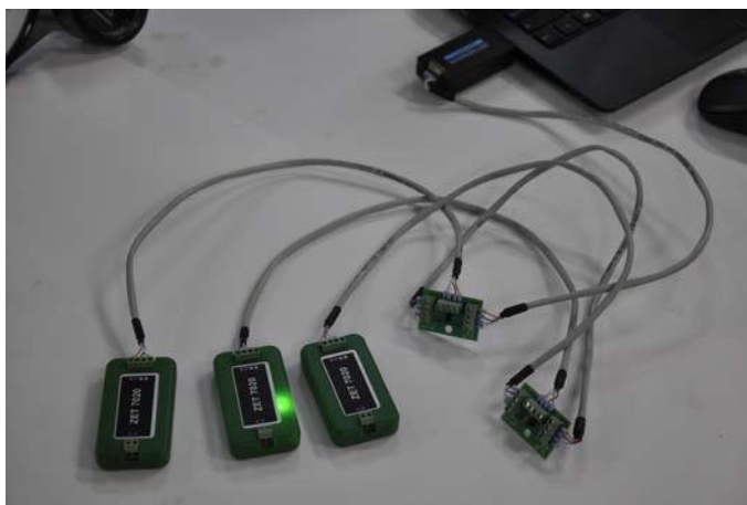
Рис. 2. ZET 7020 ТермоТС-CAN інтелектуальний термодатчик термопари с интерфейсом CAN)
