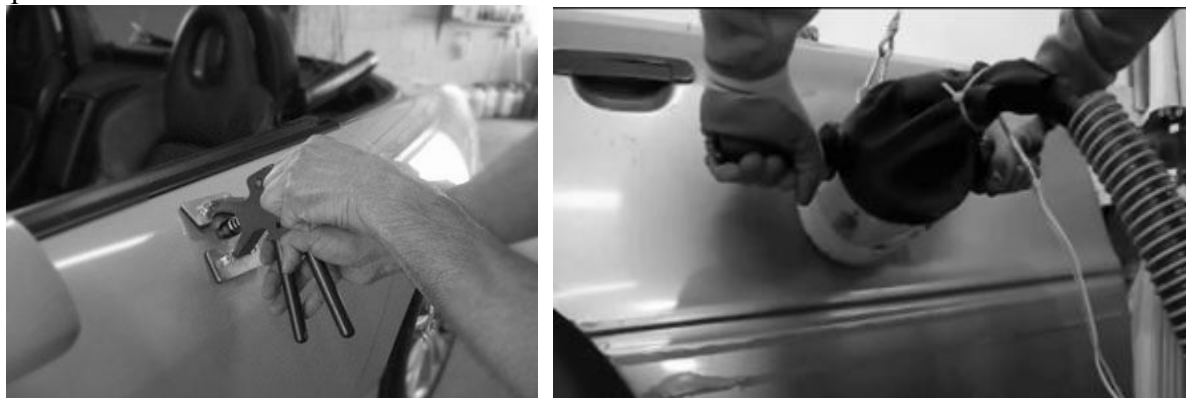
а б Рис. 1. Технології ремонту кузова легкового автомобіля: а – PDR-рихтування; б – зовнішнє безконтактне рихтування
