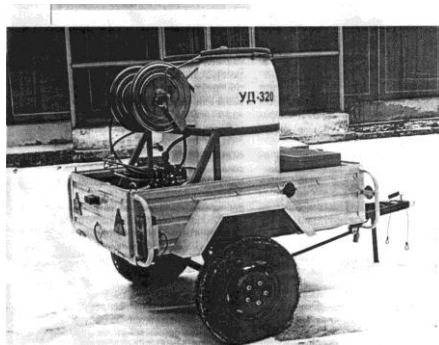
Рис. 18. Дезинфекційна установка модифікації УД-320
