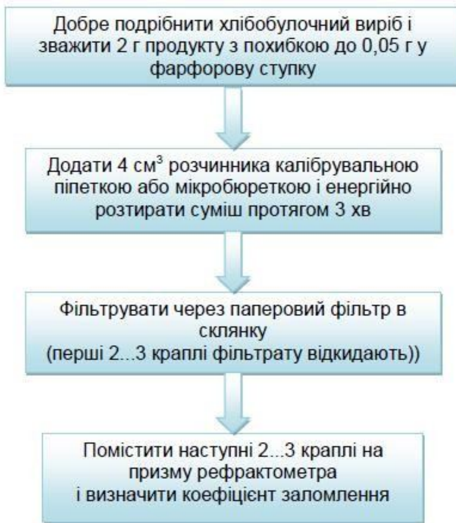
Рисунок 5.1 – Схема визначення масової частки жиру рефрактометричним методом
