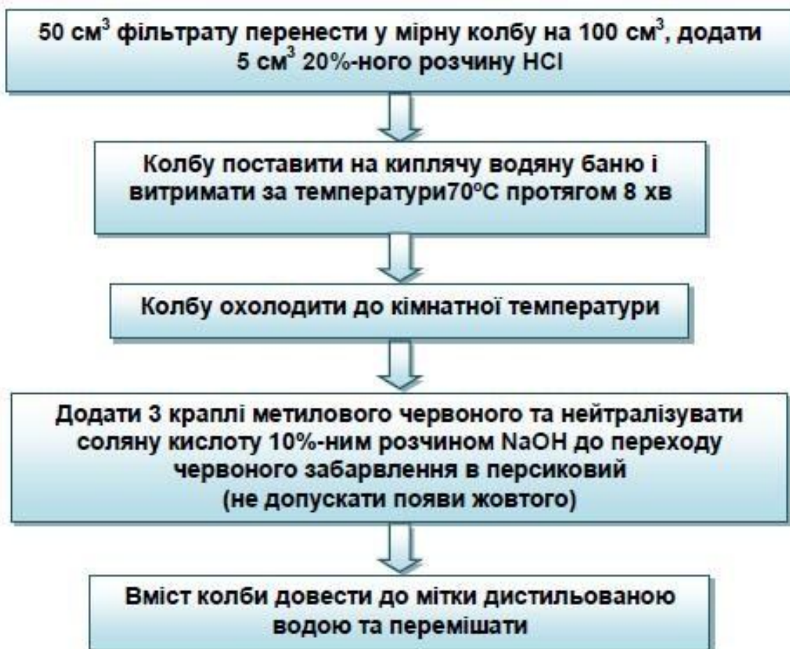
Рисунок 6.5 – Схема послідовності дій проведення гідролізу сахарози
