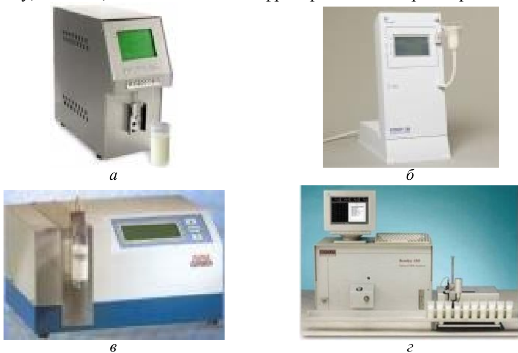
а – аналізатор молока ультразвуковий Лактоскан 60; б – аналізатор молока Клевер-2М; в – аналізатор молока LactoStar ; г – аналізатор молока Bentley 150
