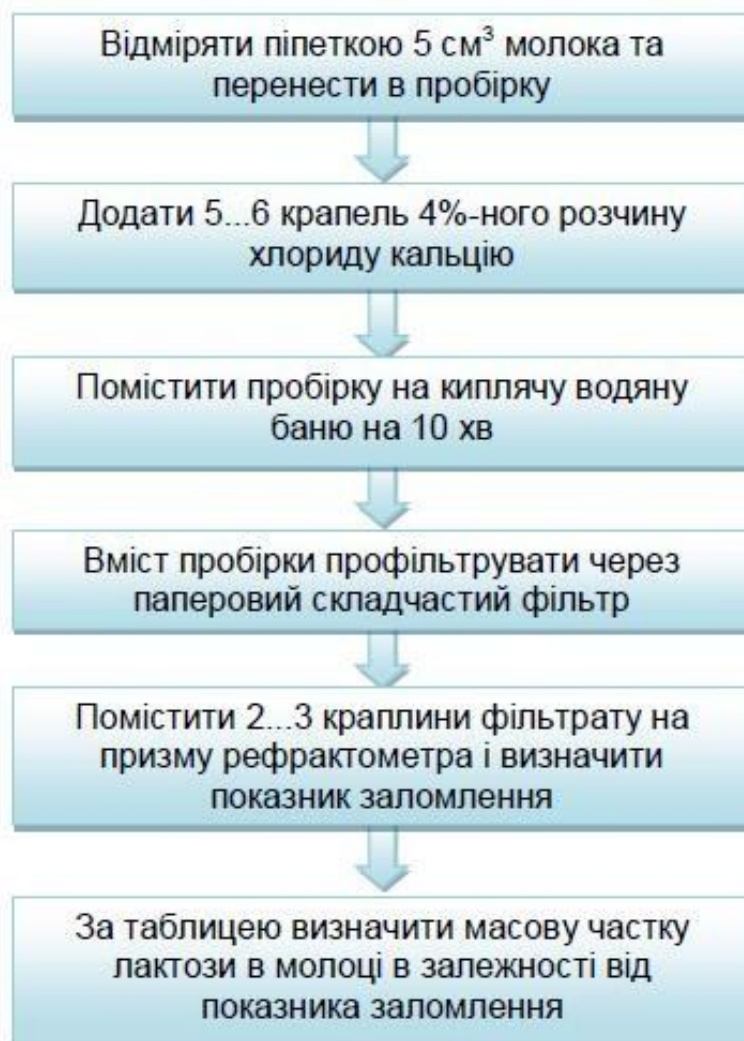
Рисунок 7.3 – Схема визначення масової частки лактози в молоці рефрактометричним методом
