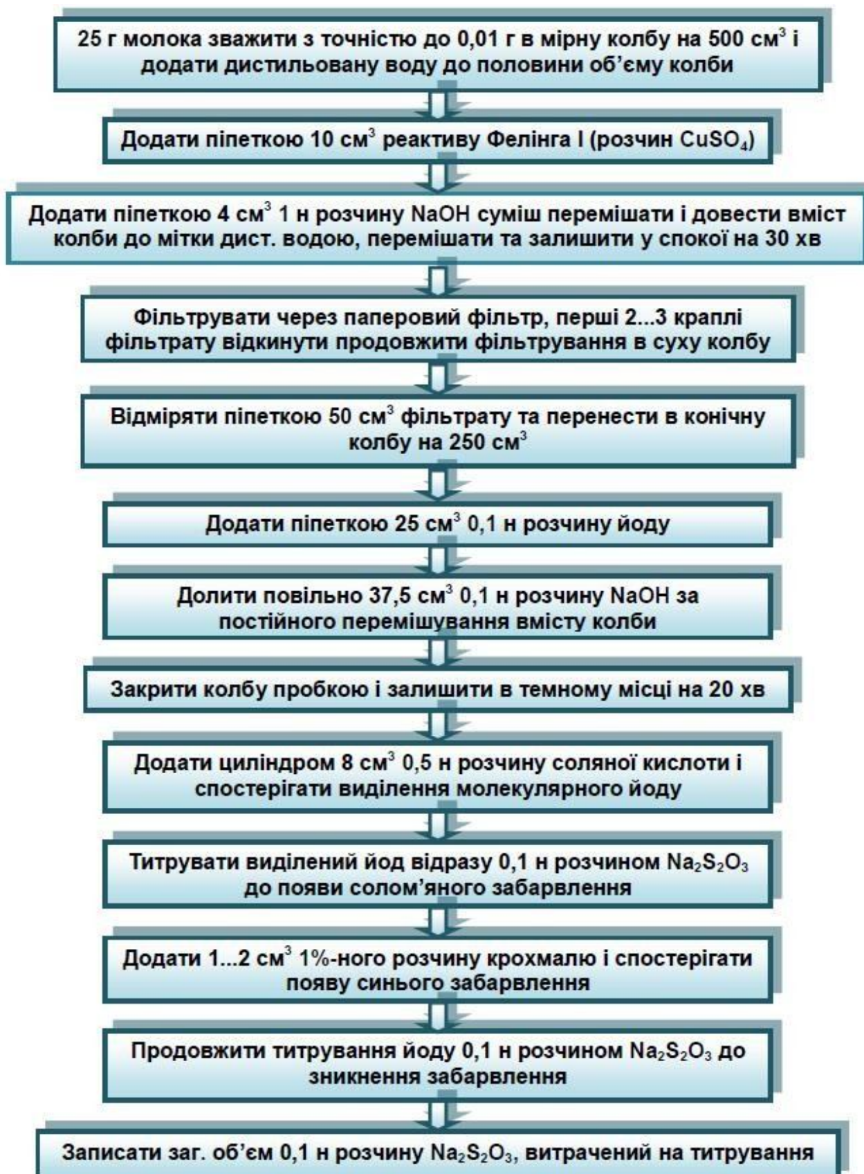
Рисунок 7.2 – Схема визначення масової частки лактози в молоці
