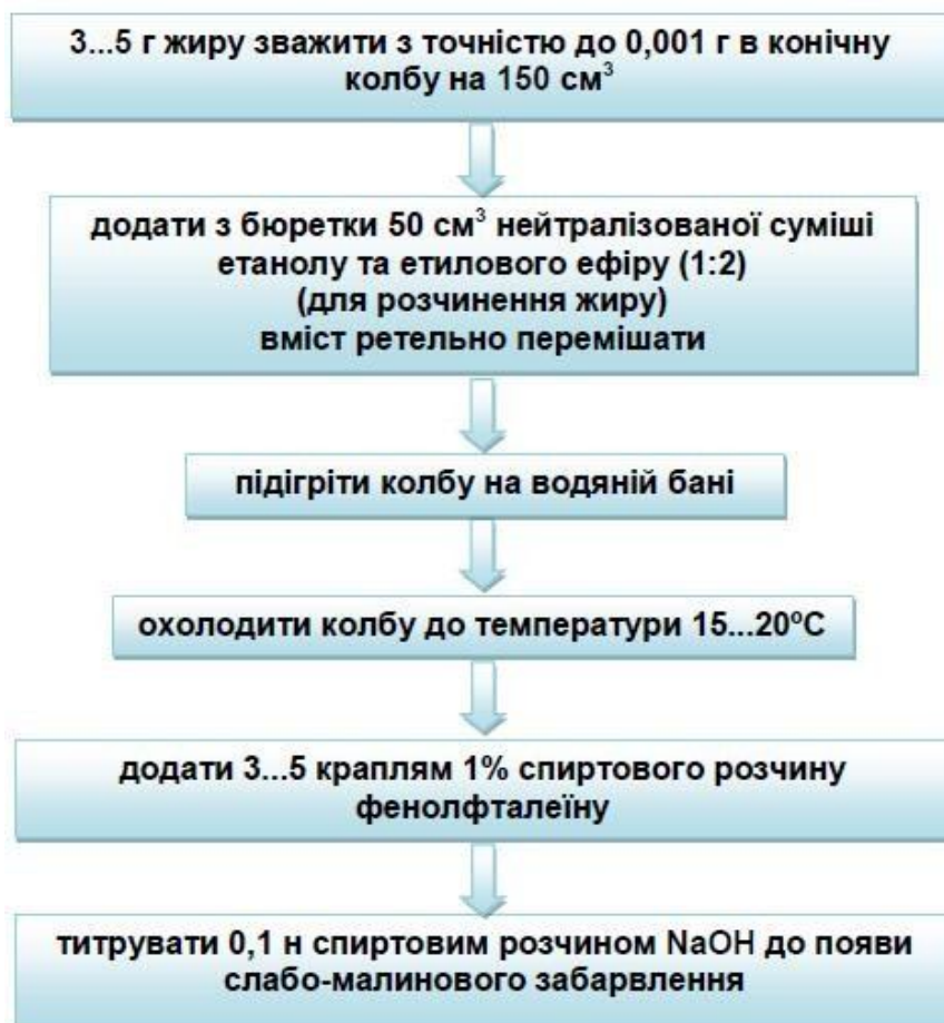
Рисунок 4.4 – Схема визначення кислотного числа харчових жирів
