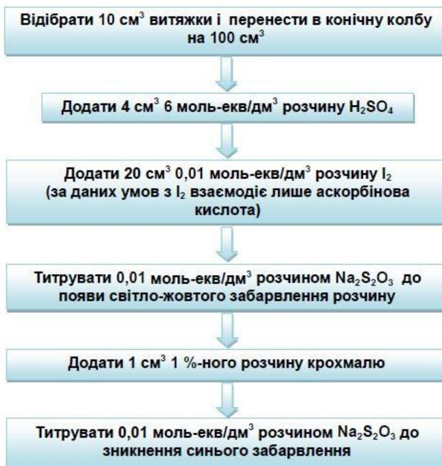
Рисунок 8.2 – Схема визначення масової частки аскорбінової кислоти йодометричним методом
