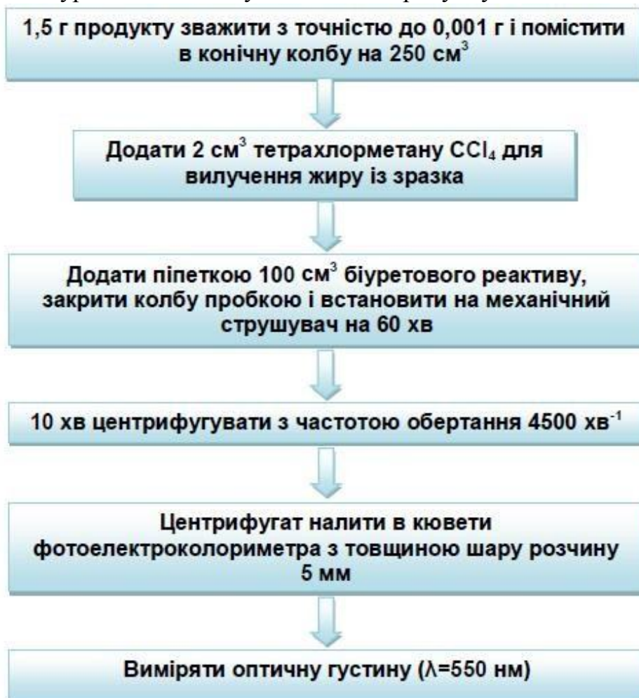
Рисунок 3.4 – Схема визначення масової частки білків біуретовим методом
