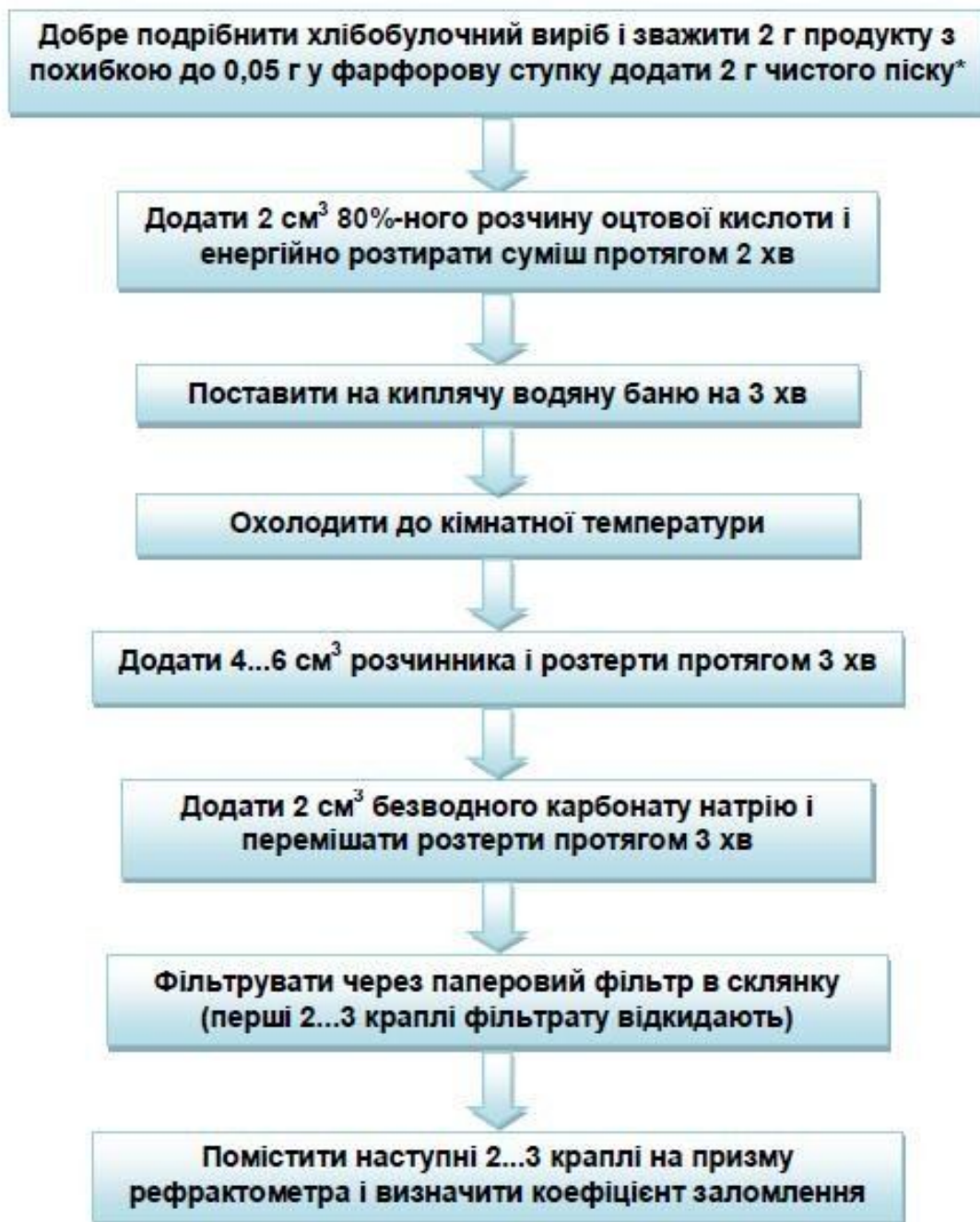
Рисунок 5.2 – Схема визначення масової частки жиру в булличових і сухарних виробках
