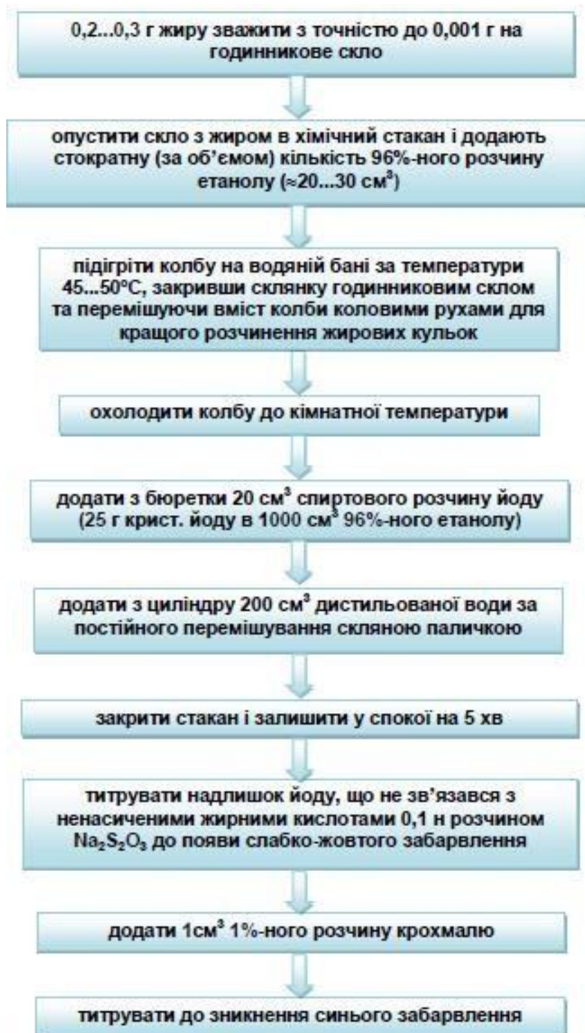
Рисунок 4.5 – Схема визначення йодного числа жиру методом Маргошеса
