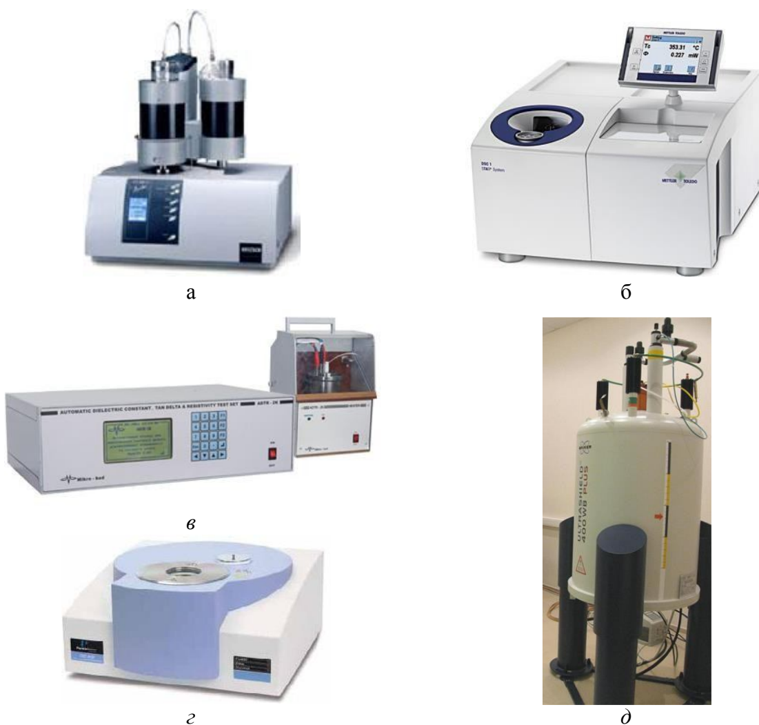
а – диференціальний скануючий калориметр DSK; б – термографічний аналізатор; в – прилад для діелектричних вимірювань; г – калориметр; д – прилад для ЯМР-спектроскопії
