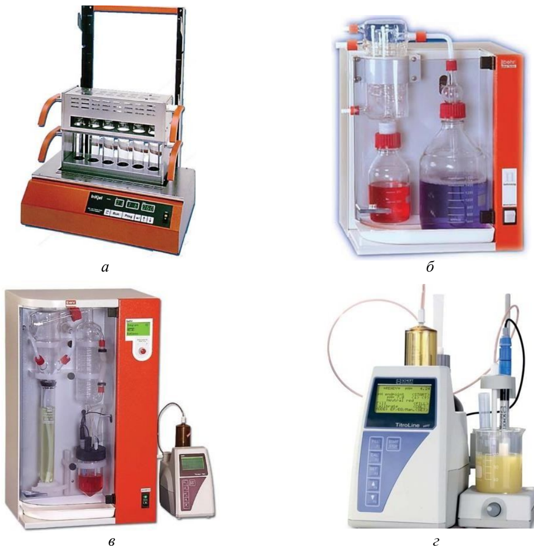
а – дигестер; б – скруббер; в – парові дистилятори; г – автоматичний титратор
