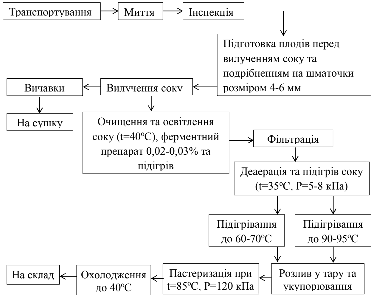
Рис.1. Технологічна схема виробництва яблучного соку освітленого
