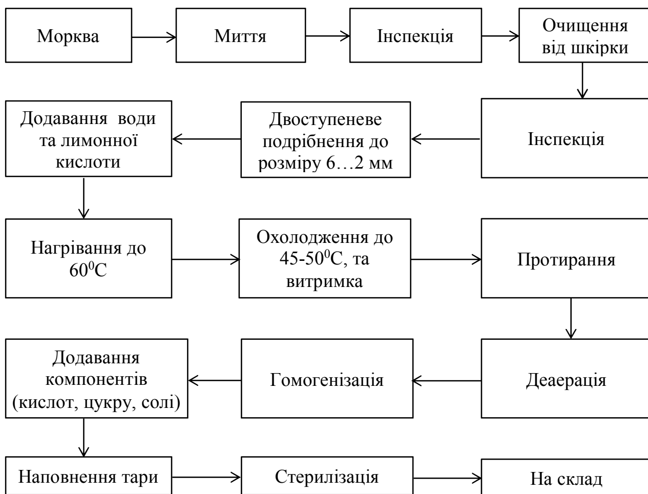
Рис. 2. Технологічна схема виробництва морквяного соку
