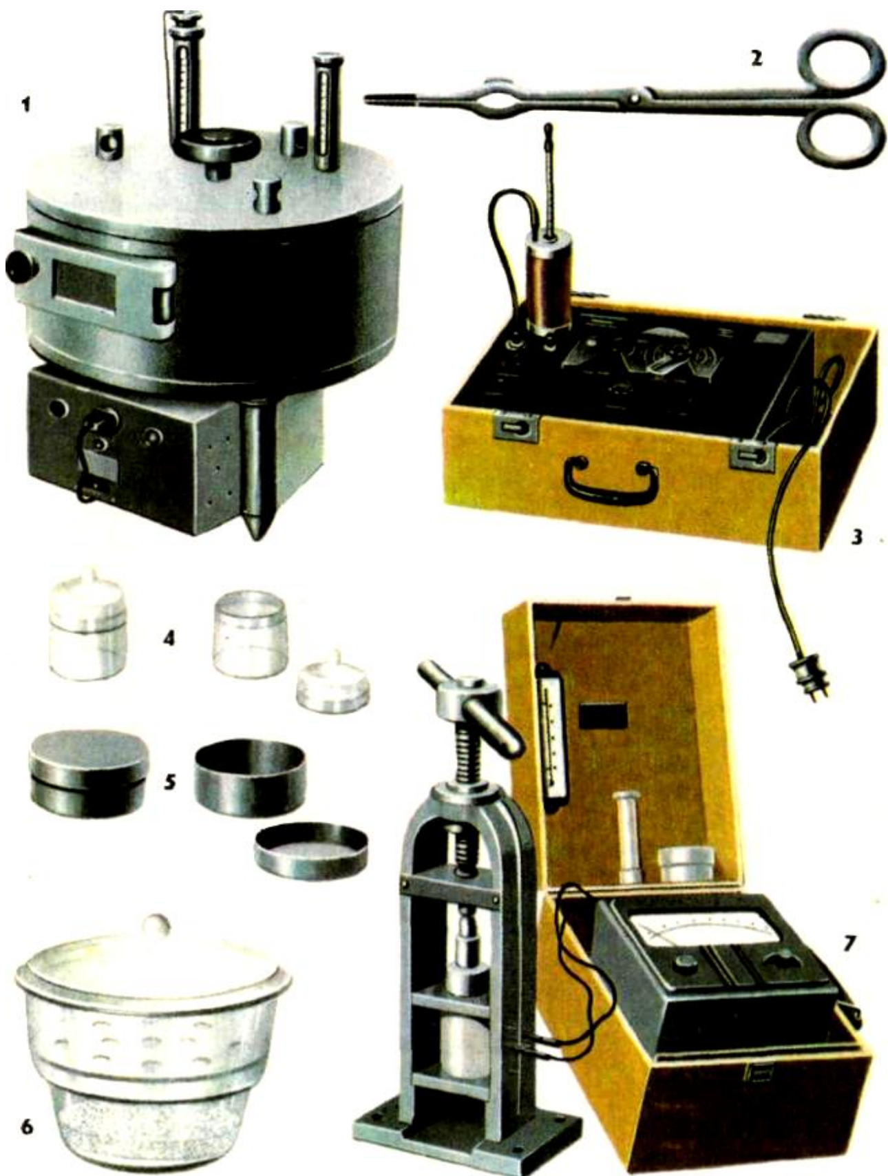
Рис. 68. Прилади та інвентар для визначення вологості насіння: 1 – сушильна шафа СЭШ-3, 2 – тигельні щипці, 3 – електровологомір «гігрорекод» Ф-8, 4 – бюкси скляні, 5 – бюкси металеві, 6 – ексикатор з хлористим кальцієм, 7 – електровологомір ВЭ-2М [39].
