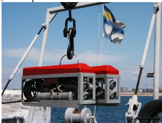
Рис. 2. Спускаемый подводный аппарат рамного исполнения «Агент – 1»
