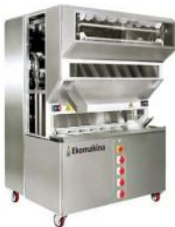
Рис. 8. Камери попередньої витримки тіста
