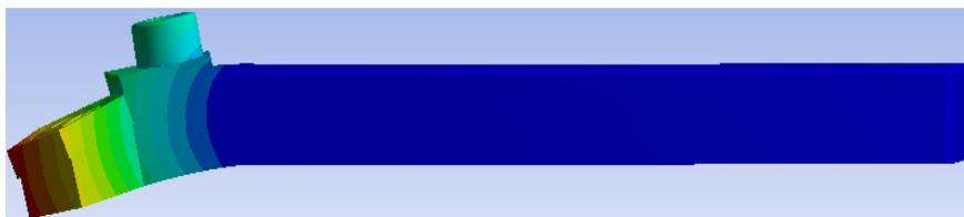
Рис. 6 – Первая изгибная форма колебаний резца при  $L = 34$  мм,  $H = 11$  мм
