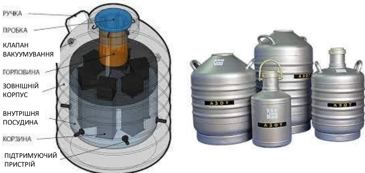
Рис. 7. Схема будови та зовнішній вигляд посудини Дьюара
