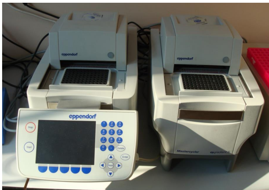
Рис. 23. Ампліфікатори – прилади, що забезпечують періодичне охолодження і нагрівання пробірок, необхідні для проведення ПЛР
