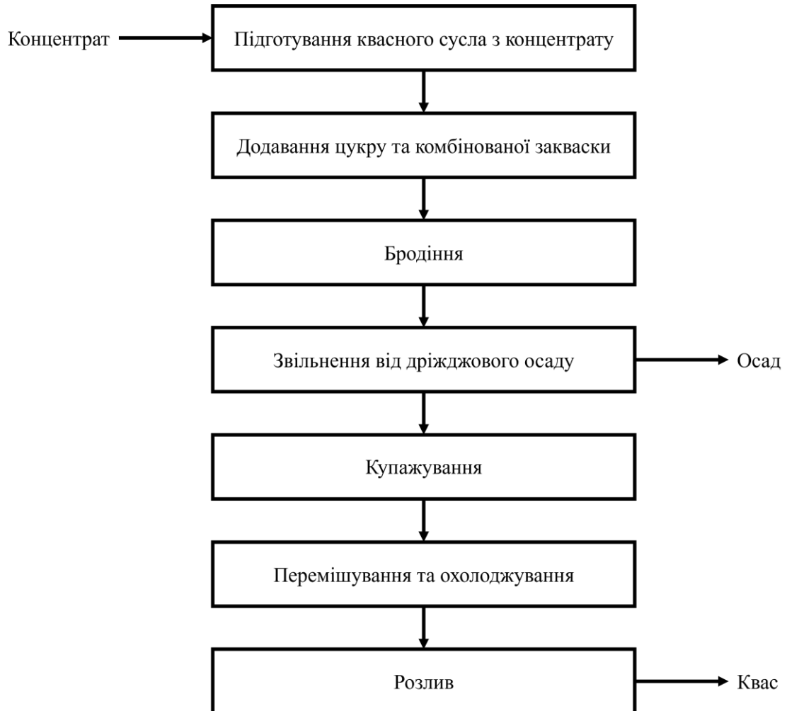
Рис. 1. Технологічна схема виробництва квасу з концентрату квасного сусла
