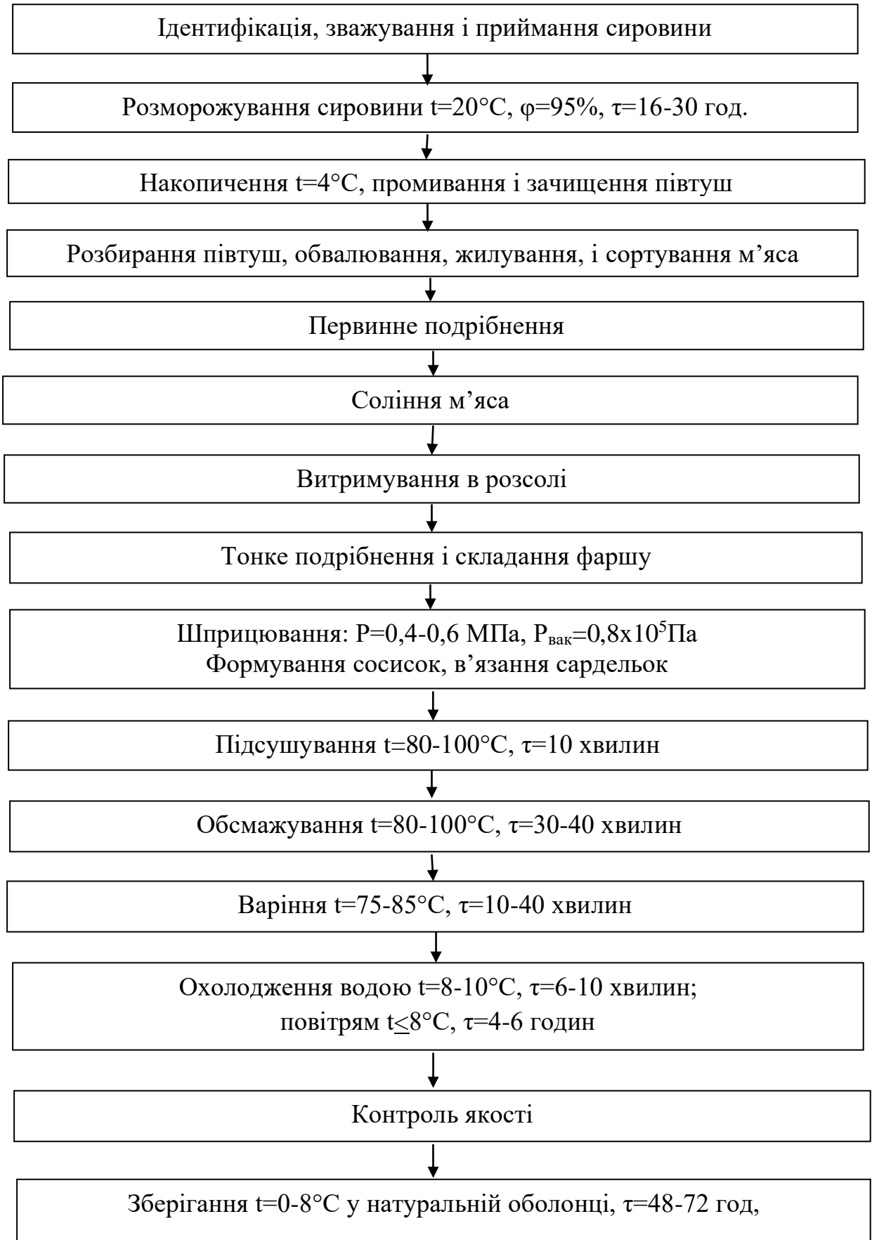
Рис. 2. Технологічна схема виробництва сосисок та сардельок
