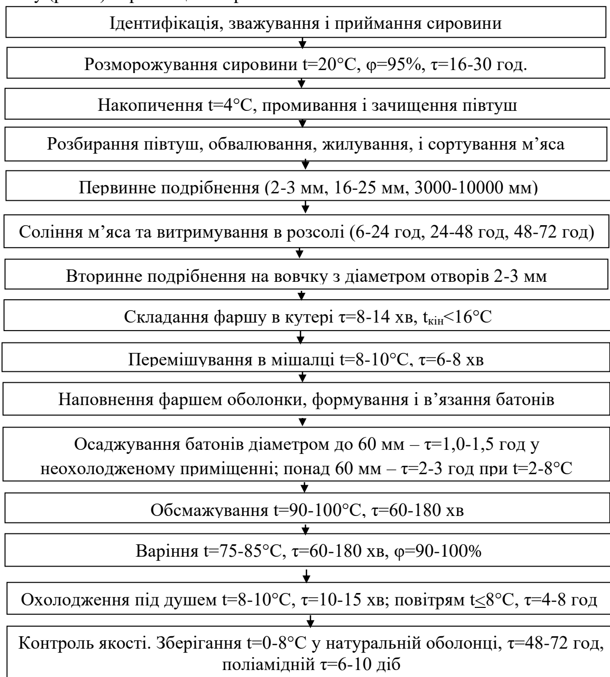
Рис. 1. Технологічна схема виробництва варених ковбас
