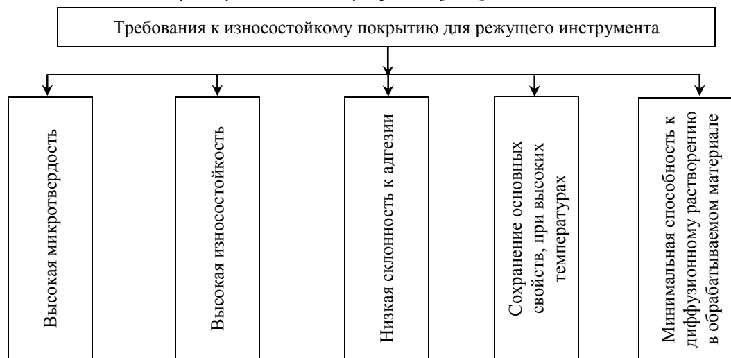
Рис. 2. Основные требования к износостойким покрытиям режущего инструмента
