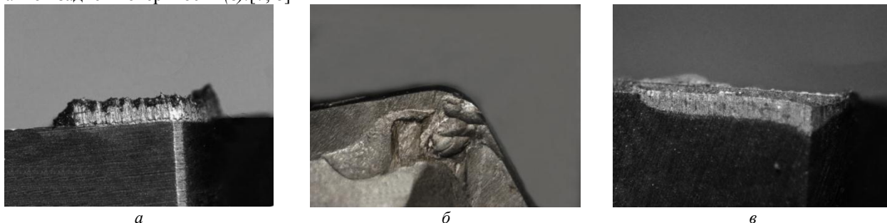
Рис. 1. Общие виды износа рабочих поверхностей резцов с наличием нароста и налива (а), скола по передней поверхности (б) и нормального износа истиранием по главной задней поверхности (в)
