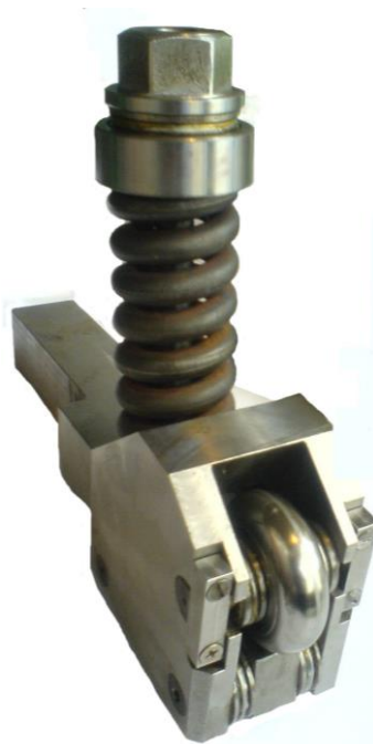
Рис. 5. Общий вид устройства для обкатывания деталей торообразным роликом со стабилизацией рабочего усилия обкатывания
